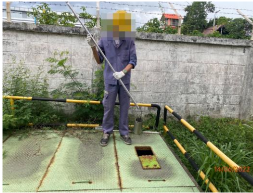
บ่อตรวจสอบคุณภาพน้ำทิ้งที่ 1 (Inspection Manhole No. 1)
